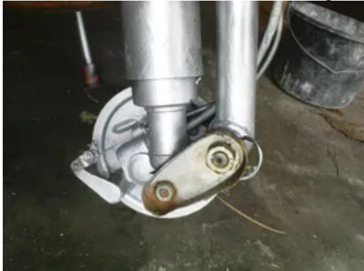
Dann muss die untere Schraube gelöst werden (13er Feingewinde)
