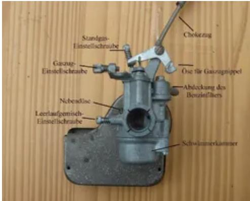
Nun wird er zerlegt. Zuerst wird die Chokedüse und der Luftfilterkasten entfernt.
