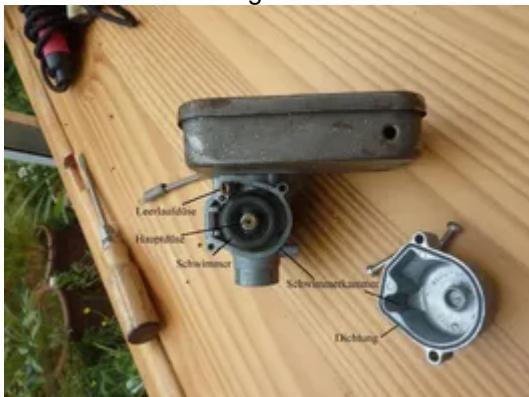
Die Hauptdüse und Leerlaufdüse wird herausgeschraubt.
