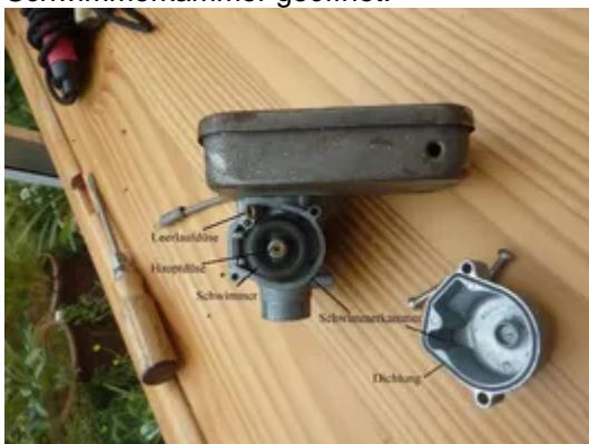
Die Hauptdüse und Leerlaufdüse wird herausgeschraubt.
