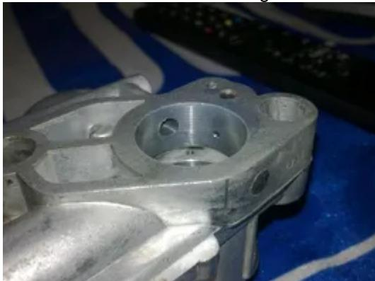
Diese Nebenöffnung versorgt den Roller im Übergangsbereich, bevor die HD die Arbeit übernimmt, weiter mit Sprit. Wenn sie aber beim Einstellen des Standgases bereits freigegeben ist kann man mit der Leerlauf-Gemischeinstellschraube nichts mehr regeln. Man hat den Schieber weit genug zu wenn der Roller gut läuft solange die Leerlauf-Gemischeinstellschraube ca. 1 Umdrehung offen ist und ausgeht wenn man sie ganz zudreht.
