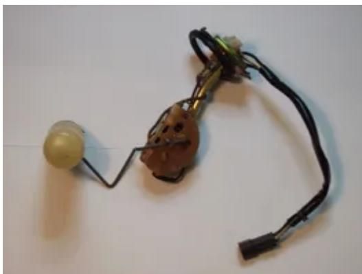
Die erste und simpelste Möglichkeit warum die Benzinstandanzeige nicht funktioniert ist, dass sich der weiße Schwimmer von dem Drahtgestänge gelöst hat und lose im Tank schwimmt. Dies kommt öfters mal vor.
