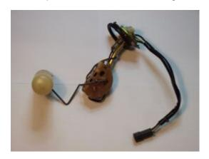
Die erste und simpelste Möglichkeit warum die Benzinstandanzeige nicht funktioniert ist, dass sich der weiße Schwimmer von dem Drahtgestänge gelöst hat und lose im Tank schwimmt. Dies kommt öfters mal vor.
