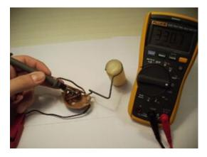
Wenn der Zeiger allerdings ganz rechts steht, bedeutet dies, dass der Widerstand sehr gering also niederohmig ist. Etwa 1,9ohm. Der Hebel mit dem Schwimmer muss also nach oben geschoben werden. Der Tank ist voll.
