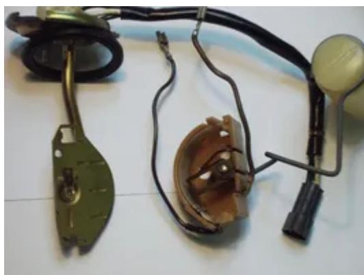
Zuerst ist es das wichtigste, zu verstehen wie der Benzinstandgeber funktioniert. Nur so kann man mögliche Fehler ausschließen bzw. ausfindig machen. Deshalb hier die Erläuterung:
