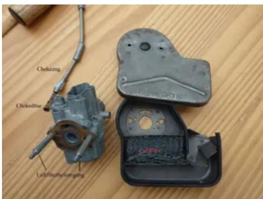
Dann wird die Benzinfilterabdeckung aufgeschraubt und der Filter entnommen.
