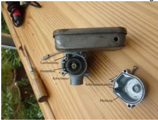
Die Hauptdüse und Leerlaufdüse wird herausgeschraubt.
