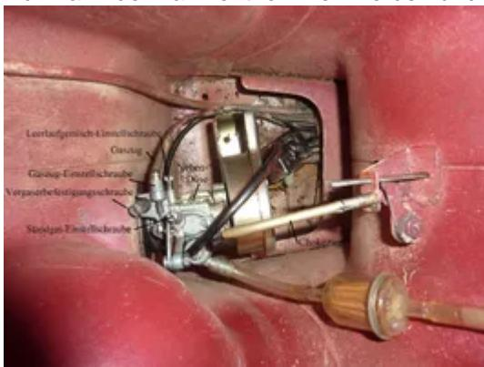
Der [Benzinschlauch](#), hier noch am Vergaser festgemacht, wird abgezogen und der Chokezug am
