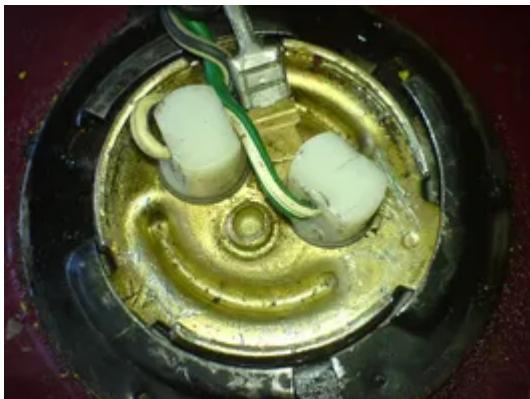
Um an den Tankgeber und die Kabelverbindungen zum testen zu kommen, muss man den inneren Teil gegen den Uhrzeigersinn drehend öffnen. Dazu ist der hochstehende Rand darauf gedacht.
