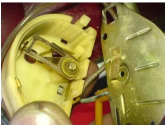
Ist am Messwiderstand keine Beschädigung zu erkennen, sollte man folgende Stellen mit einem kleinen Schraubenzieher oder kleiner feiner Feile oder Ähnlichem bearbeiten:
