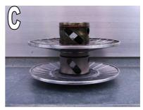
Der Austausch der originalen Variomatik bringt eine gleichmäßigere und auch schnellere Beschleunigung. Um dieses Ergebnis noch einmal zu optimieren und um somit jegliche Verzögerung zu unterbinden, kann zusäztlich die hintere Riemenscheibe von Malossi (=Torque Driver) verbaut werden (Bild B+C). Hierbei gilt: Je steiler die Steigung der Nut, desto schneller wird die Übersetz= ung geändert und desto besser ist die Beschleunigung.
