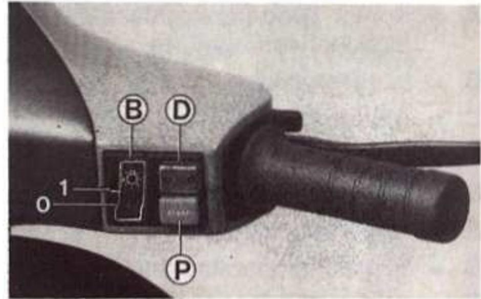
Eine Anlasserschutzeinrichtung am Hinterradbremsshebel verhindert ein versehentliches Starten. Diese Schutzeinrichtung gibt erst dann den Kontakt für den Anlasserstrom frei, wenn der Hinterradbremsshebel gezogen ist.
