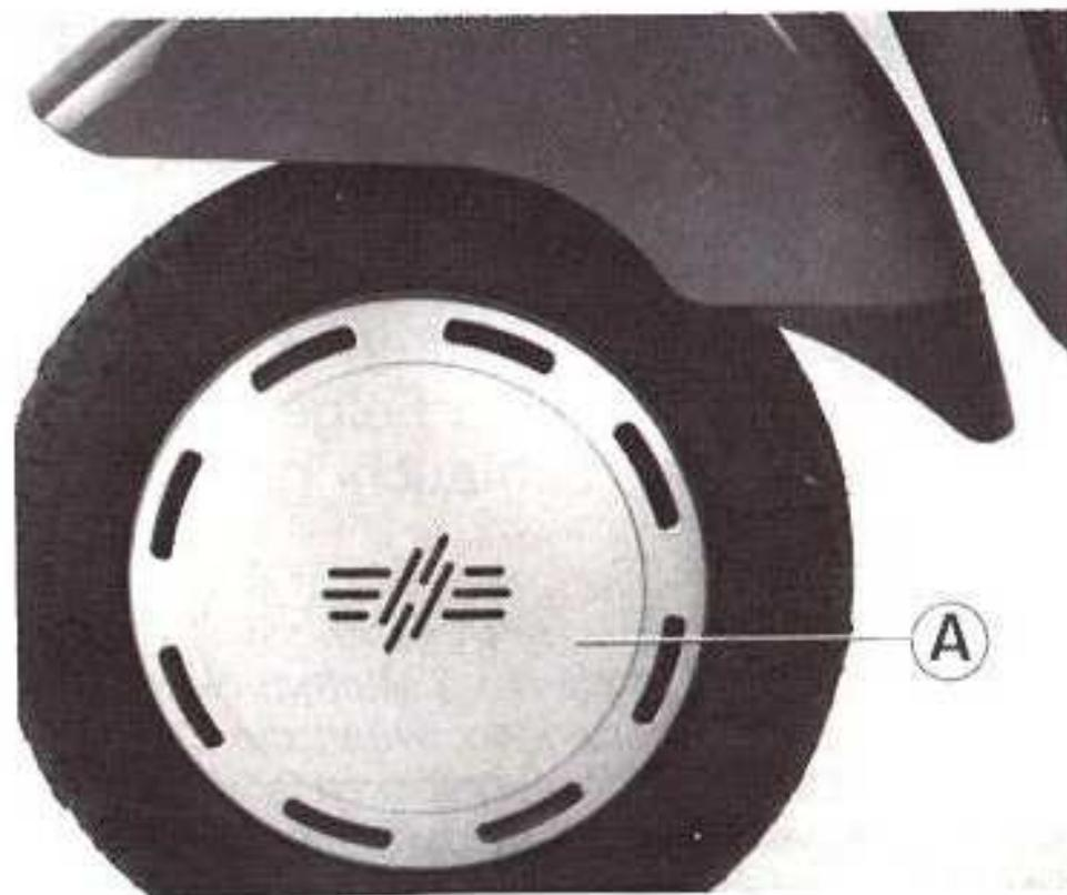
alle 10 Muttern auf einer Felgenseite sichtbar, ist das Rad falsch montiert - auf keinen Fall fahren, da die Befestigungen an der Bremstrommel brechen können.
