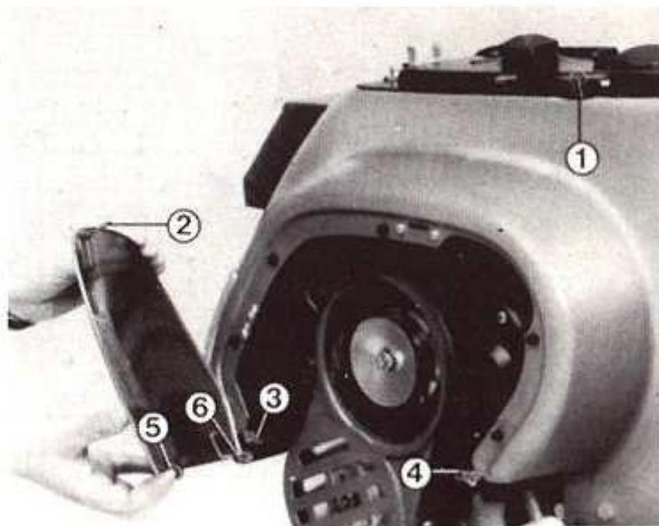
**Achtung:** Bauen Sie nie die rechte Seitenklappe bei laufendem Motor ab, da dabei Verletzungsgefahr durch das rotierende Lüfterrad bestehen kann.
