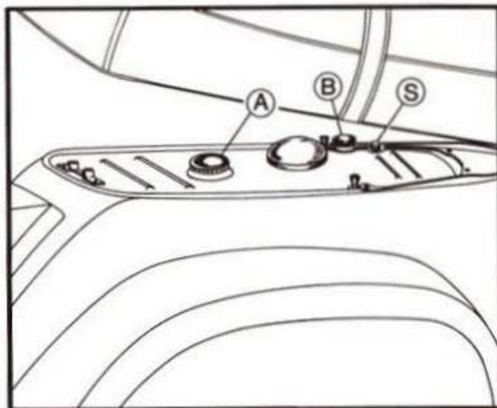
A = Benzintank; B = 2-Taktöltank; S = 2-Taktölstandsanzeiger.
