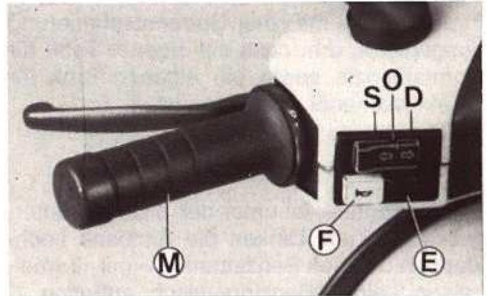
**Achtung:** Vor jedem Starten den Schaltdrehgriff in die Getriebeleerlaufstellung bringen, erst nach dem Start in die Getriebefahrstellung drehen. Die Umschaltung von der Getriebeleerlaufstellung in die Getriebefahrstellung nur bei Leerlauf des Motors (Gasdrehgriff nicht aufdrehen) vornehmen.
