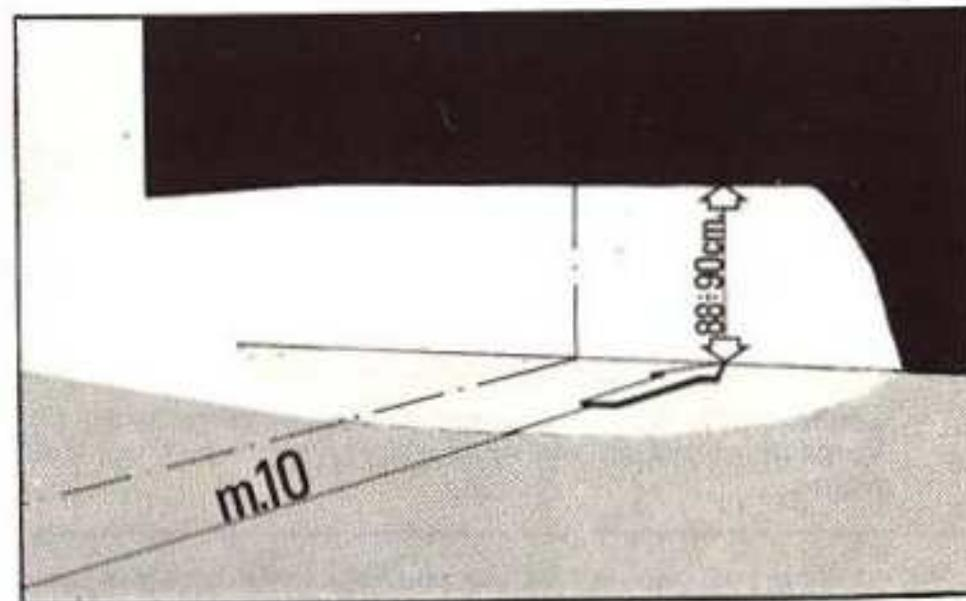
lastung vorgenommen werden. Zur Scheinwerfereinstellung die untere Schraube am Scheinwerfereinsatz lösen, einregulieren und festziehen.
