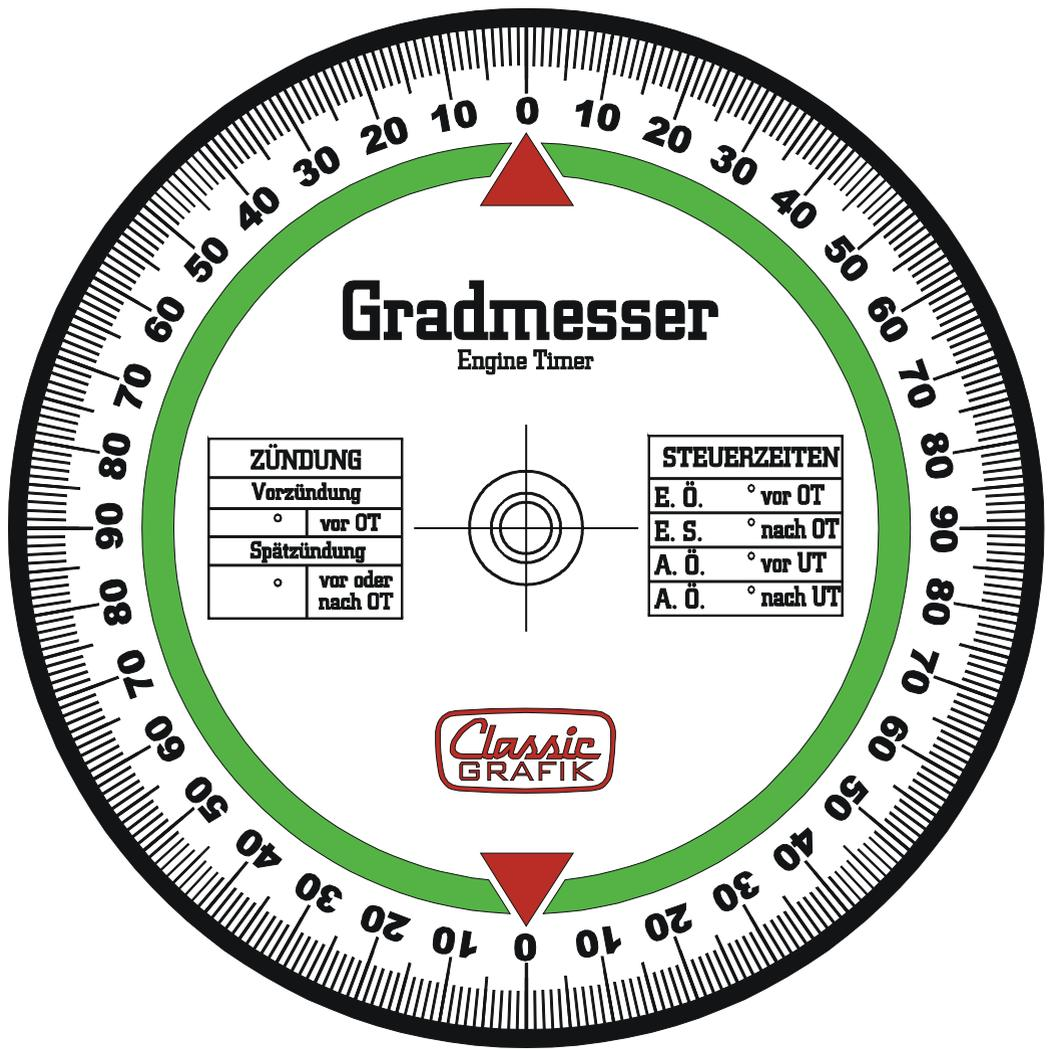
Gemäß Kurbelwellenzapfen-Durchmesser zentrisches Loch schneiden.
