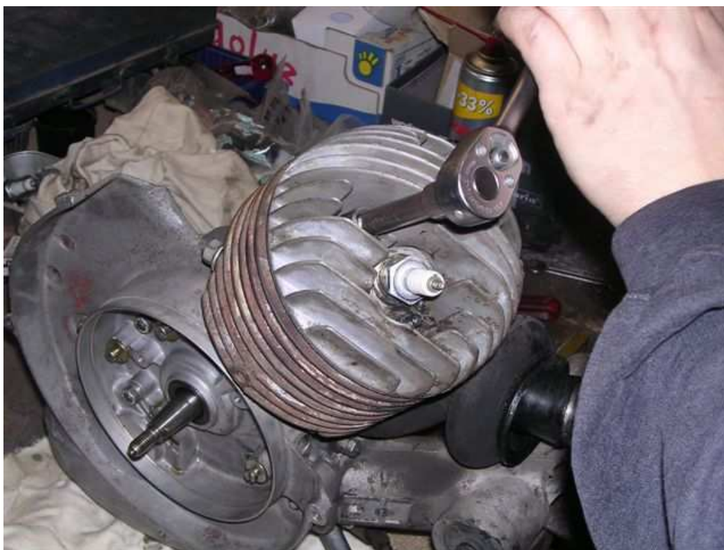
- Zylinderkopfschrauben lösen
