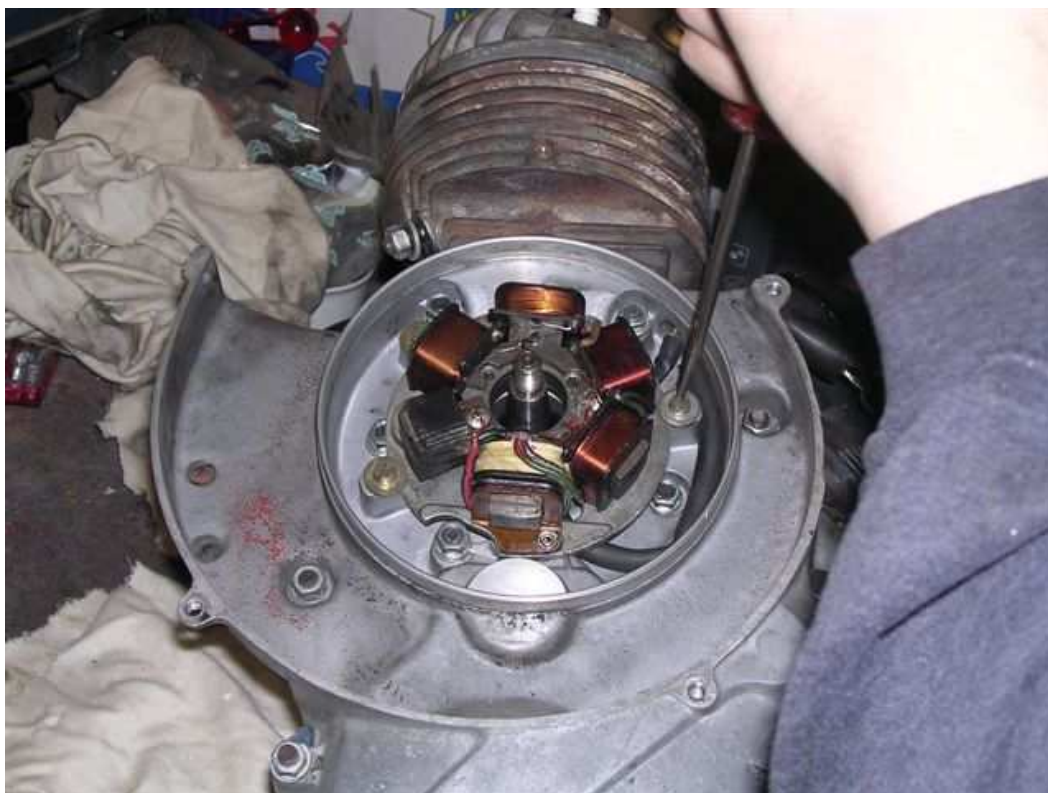
- Schrauben der Zündgrundplatte lösen
