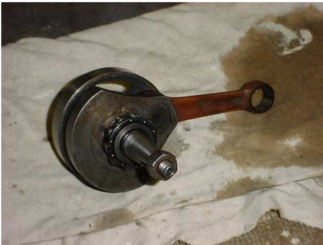
- Kurbelwelle wurde mit Plastikhammer rausgeklopft - Kurbelwelle mit Lima-Lager NU204 -> zum Empfehlen (Standard Walzlager bei ET3...bei anderen oft Kugellager 6204)
