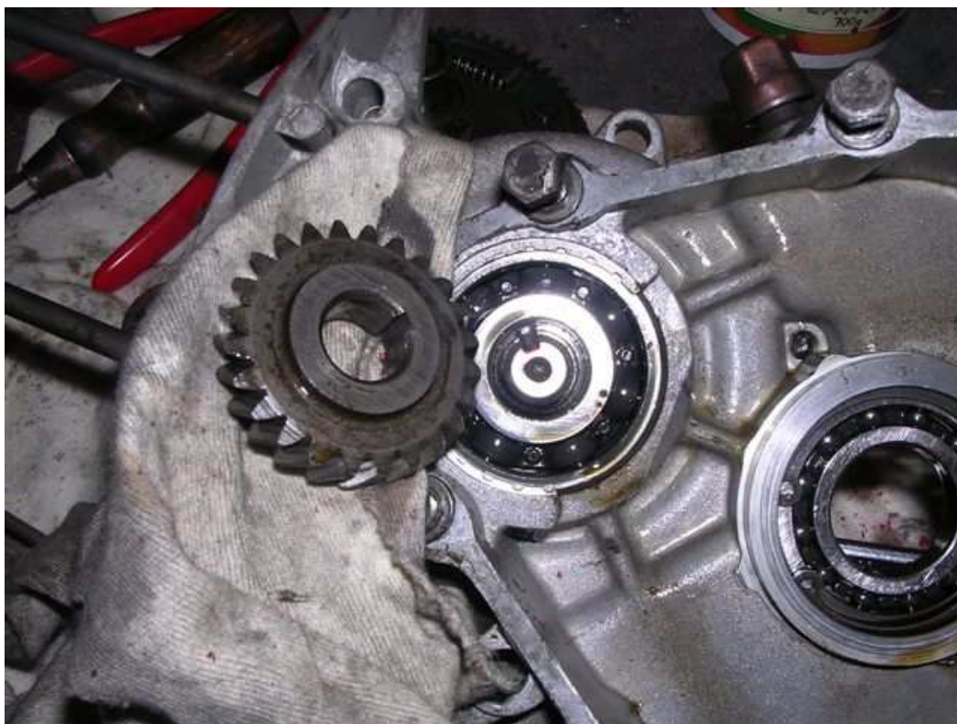
- Primärzahnrad und Keil entfernen
