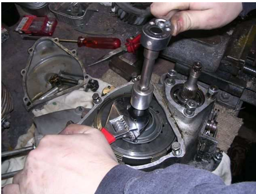
- mit Gabelschlüssel kontern und mit Ratsche Abzieher-Schraube reindreihen
