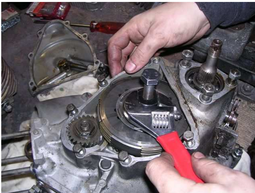
- mit Gabel(roll)schlüssel anziehen
