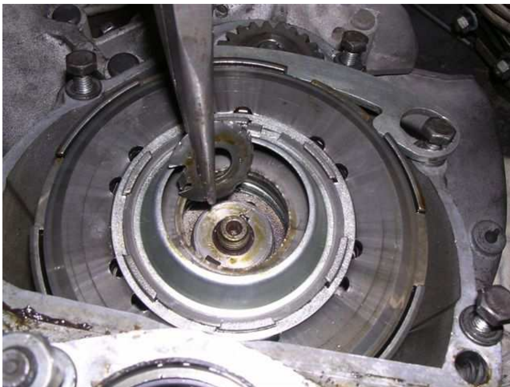
- Sicherungsplatte rausnehmen
