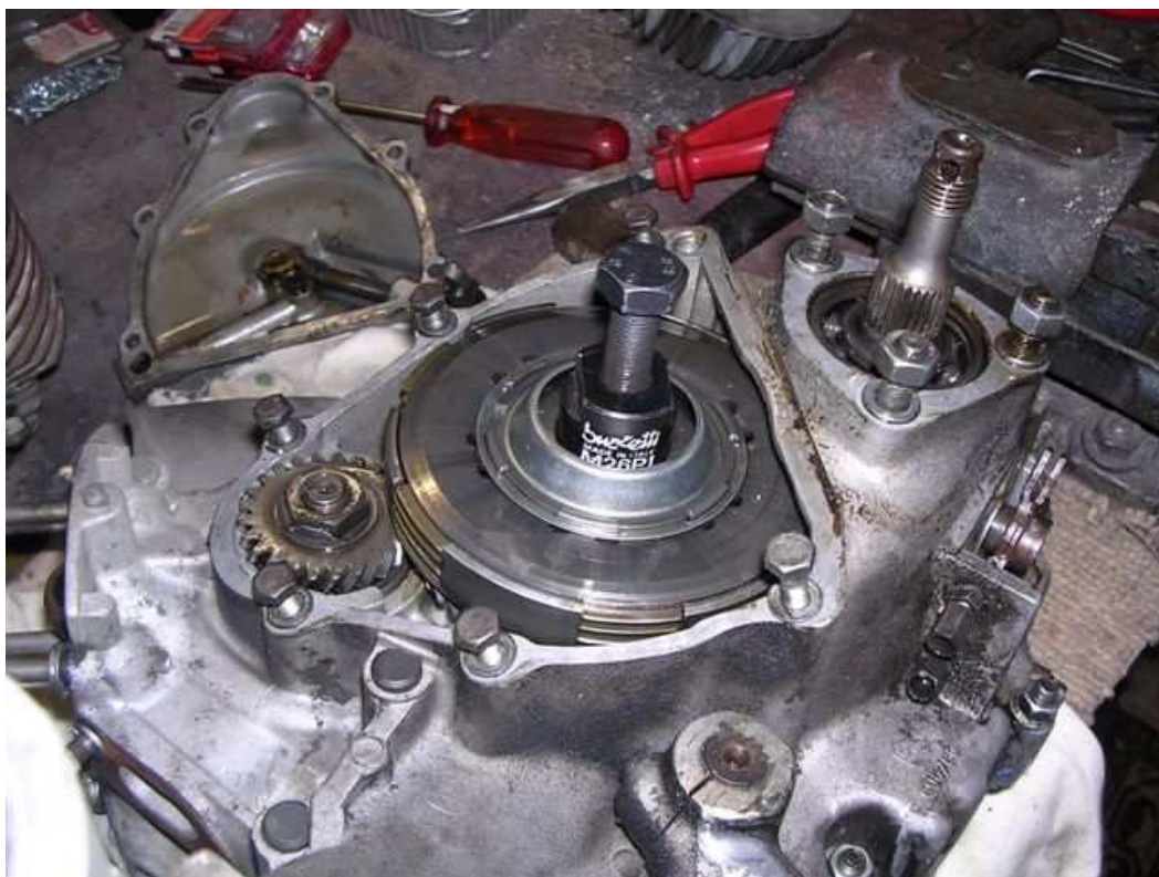
- angesetzter Kupplungsabzieher
