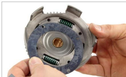
Deckplatte in die Primärübersetzung legen.
