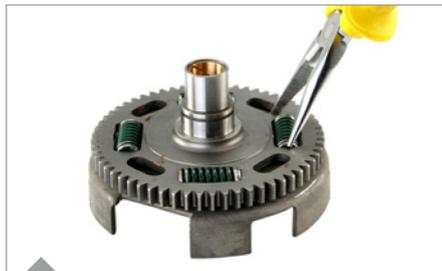
Primärfedern in Primärzahnrad mit Zange einbauen.
