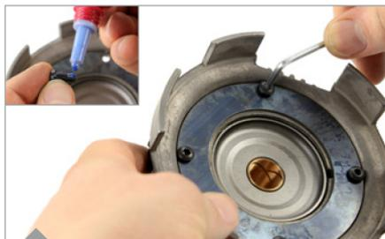
Mit Schraubensicherung Art.-Nr. 141000 die Schrauben des Reparaturkits sichern. Die 4 Schrauben mit Inbusschlüssel zudrehen.
