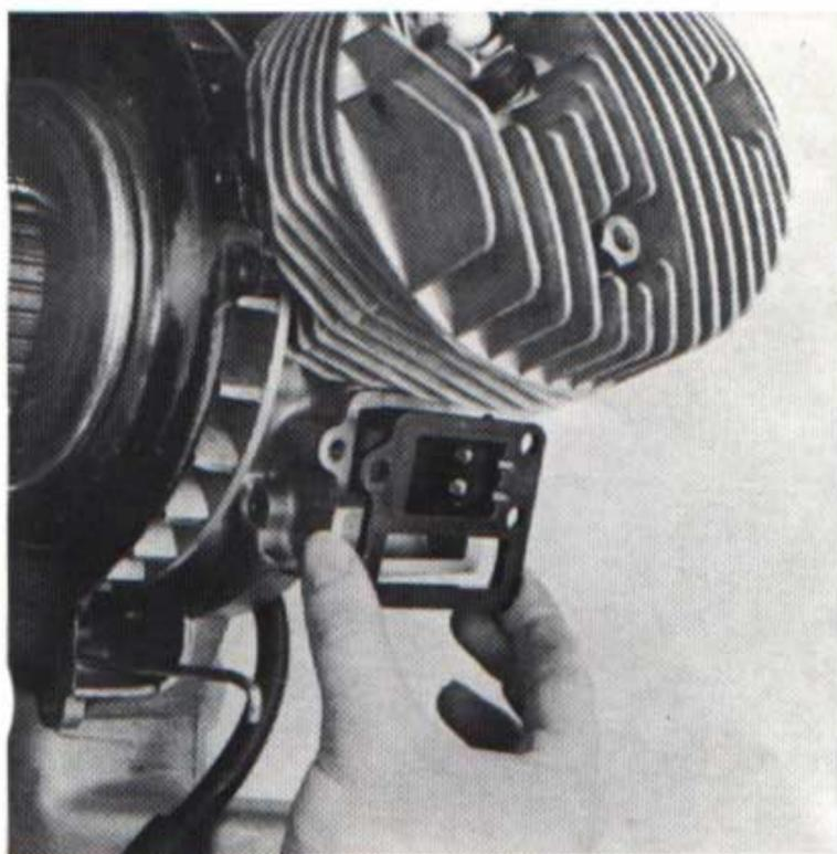
8) Membrankasten mit Dichtung abnehmen.
