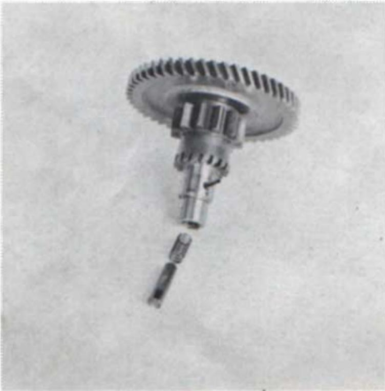
8) Feder mit Antriebswelle für die Hydraulikpumpe.
