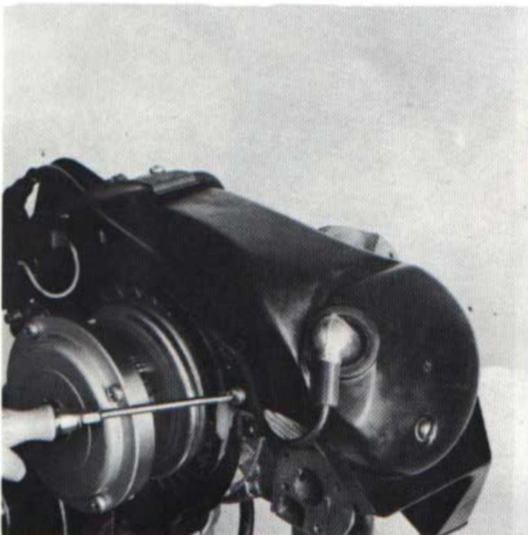
5) 3 Schrauben lösen, Lüfterhaube abnehmen.
