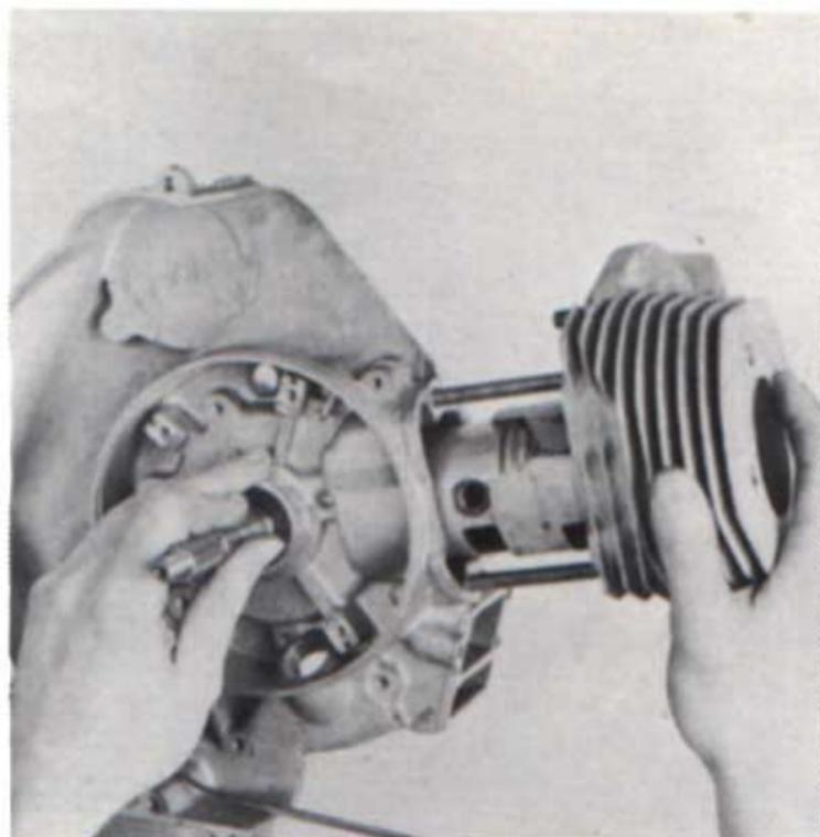
25) Fußdichtung und Zylinder montieren.
