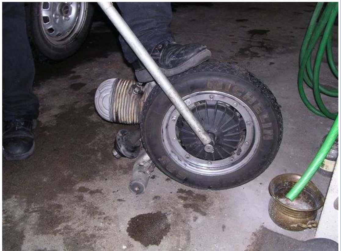
oft kriegt man die radkronenmutter nicht wirklich gut auf. bevor man es mit fäustl und co versucht, sollte man besser mit den hebelgesetzen arbeiten. ratsche rauf, rohrverlängerung ran und mutter lösen. die mutter darf natürlich bereits vorher im eingebauten zustand gelöst werden 😊
