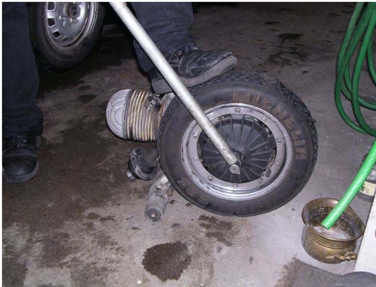
oft kriegt man die radkronenmutter nicht wirklich gut auf. bevor man es mit fäustl und co versucht, sollte man besser mit den hebelgesetzen arbeiten. ratsche rauf, rohrverlängerung ran und mutter lösen. die mutter darf natürlich bereits vorher im eingebauten zustand gelöst werden 😊
