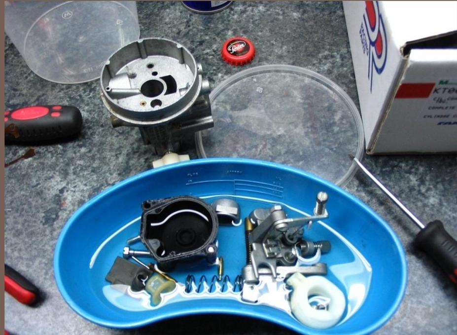
Neuer Lack für den Auspuff und reinigen der Vergasers –
