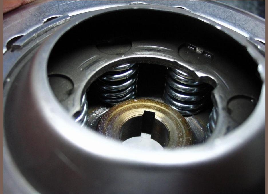
Die Kupplung, neue Beläge und verstärkte Federn – damit die 75ccm auch auf die Strasse kommen.
