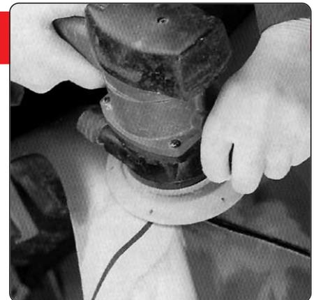
Die Schweißnaht muss zur Erzielung einer glatten Oberfläche zuerst mit einer Schleifscheibe mit Körnungsnummer 120, dann mit Nummer 180 und schliesslich mit Nummer 320 abgeschliffen werden. Will man die Glätte noch weiter verbessern, so kann man das mit sehr feinem Schmiergelpapier erreichen. Bis zu 10 cm zu beiden Seiten der Naht als Haftgrund aufrauen, aber nicht überglätten.
