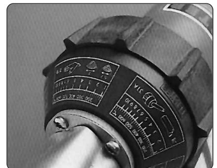
*Die auf dem Gerät angebrachten Temperaturskalen geben die genaue Einstellung für die verschiedenen Düsen und Temperaturen an.*
