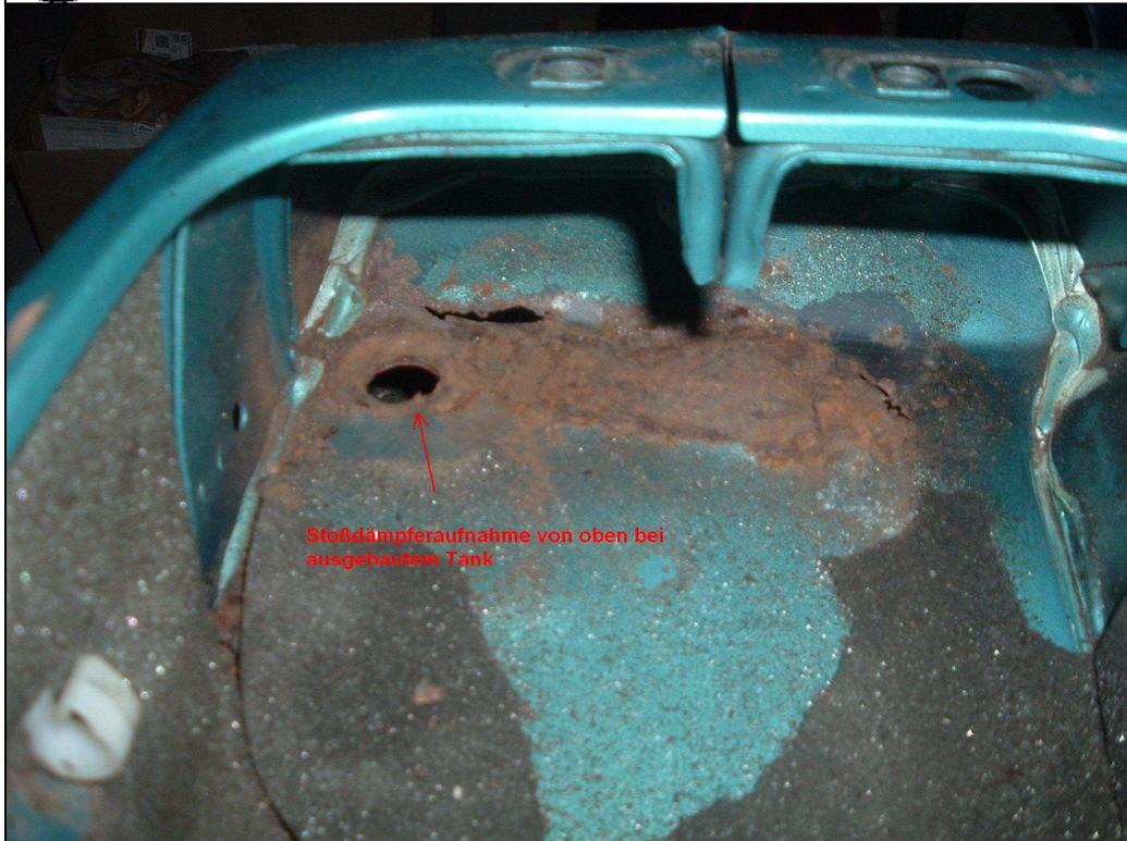
Bild 09 Roststelle Stoßdämpferaufnahme bei ausgebautem Tank von oben.
