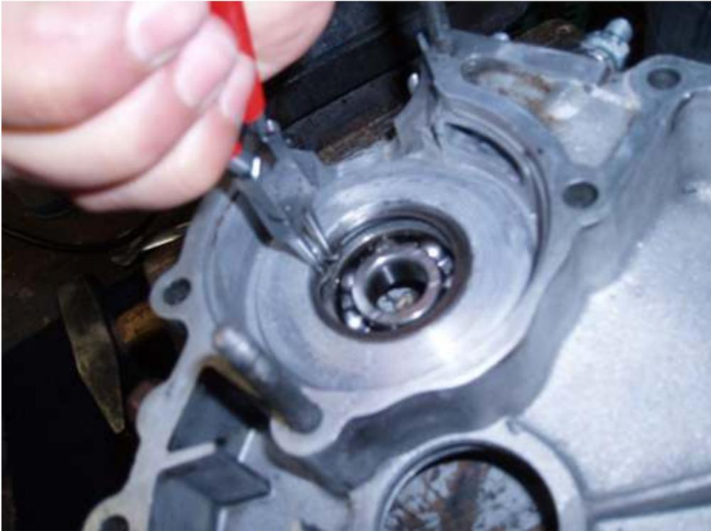
Mittels Seegeringzange wird der Seegering montiert
