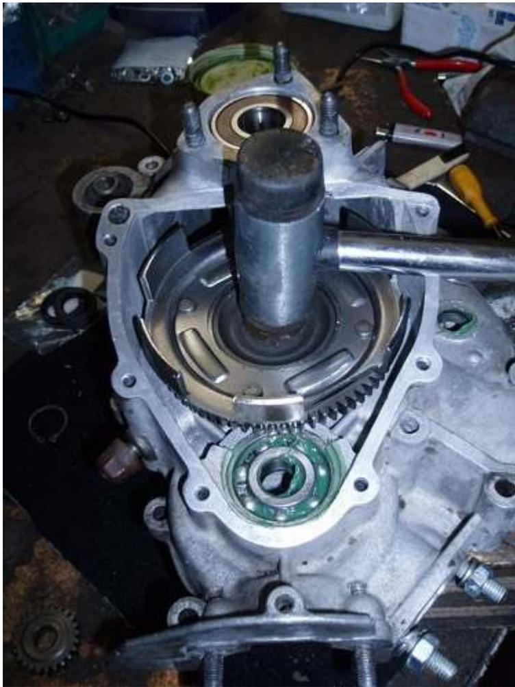
Primärgetriebeübersetzung mittels KST-Hammer bis Anschlag reinklopfen
