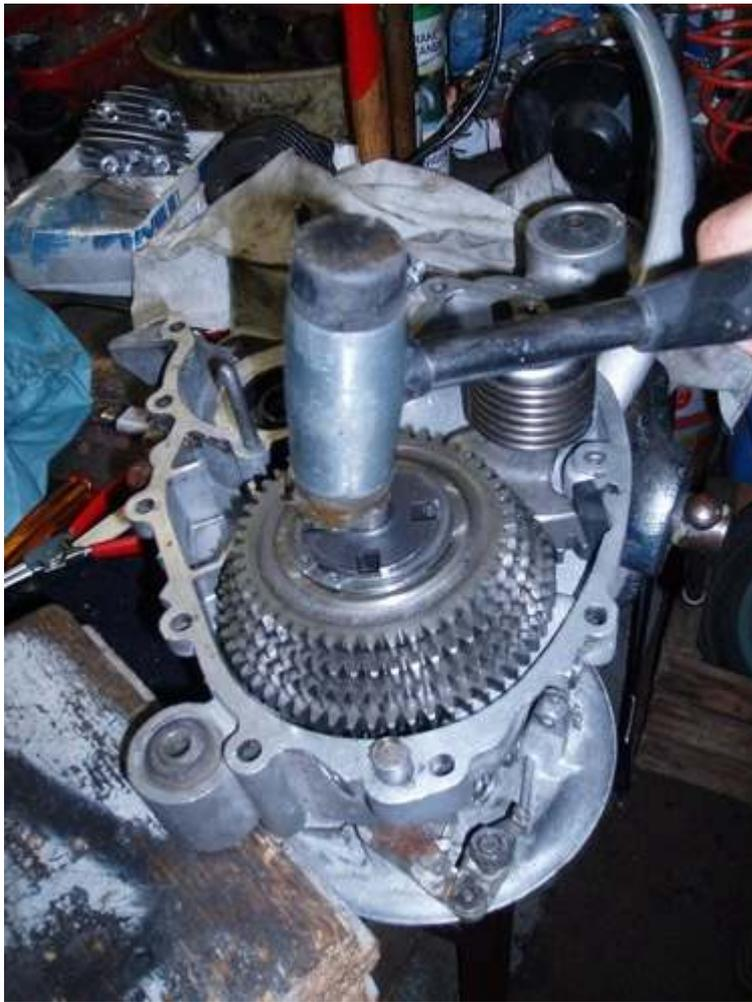
Getriebe mit Kunststoffhammer bis Anschlag reinklopfen.
