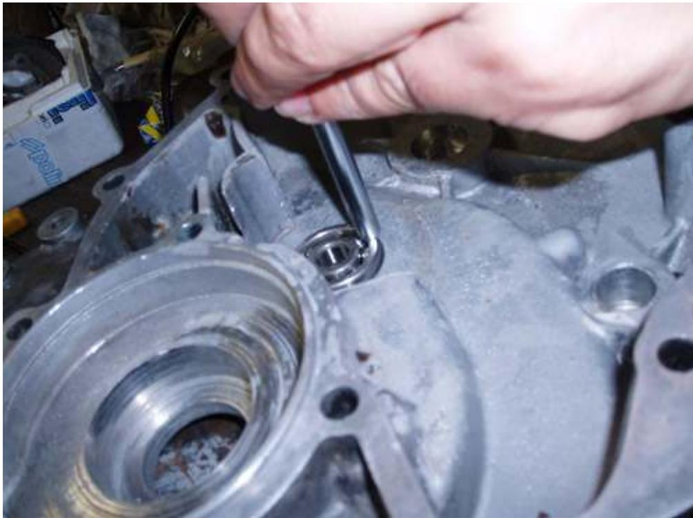
Mit einem Durchschlag und Hammer wird das Lager reingeklopft. Man kann hierfür auch eine alte passende Ratschen-Nuß zum Reinklopfen hernehmen
