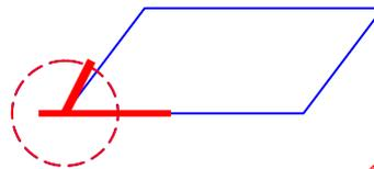
Ist die Drehachse **vertikal nach unten** oder **horizontal nach links** verschoben, kann der Hebelarm von seiner Lagerung auf der Querstrebe abrutschen, Da der Versatz mit steigender Hubhöhe größer wird.
