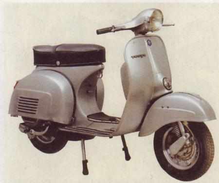
125 TS: Ein dritter Überströmkanal sorgt für mehr Leistung, das Fahrwerk entspricht der 200 Rally
