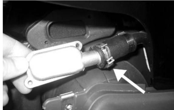
Die Leitung zur Abgasentnahme richtig an die Gummimuffe der Nebenluftleitung anschließen. Um falsche Messwerte beim Ablesen des CO-Wertes zu vermeiden, muss darauf geachtet werden, dass der bei dem o. a. Anschluss keine Falschlucht zugeführt wird.
