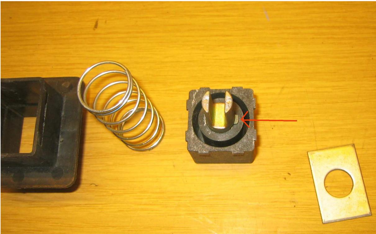
wenn man diese hinein drückt, kann man den Schließzylinder nach unten heraus drücken. Bei der Montage, in umgekehrter Reihenfolge, darauf achten, dass der Plastik-Schlosskörper eine Nase hat. An der Bank ist die entsprechende Aufnahme dafür.
