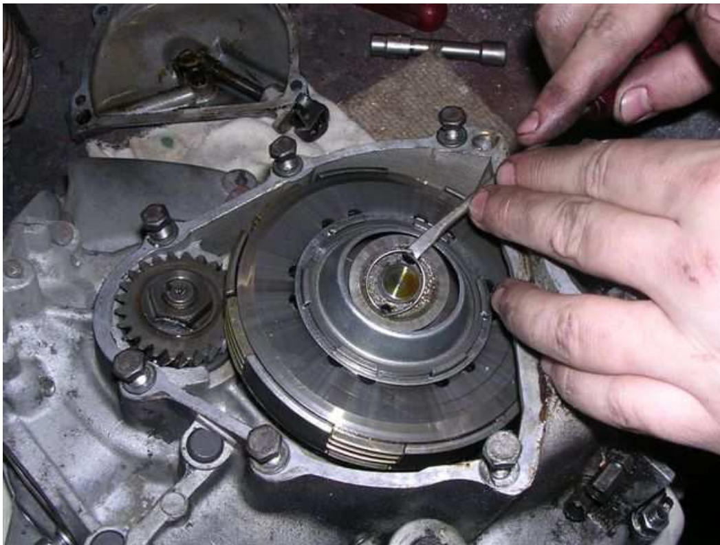
- Kupplungsdruckplatte entfernen. Feder mit Schraubenzieher rausdrücken
