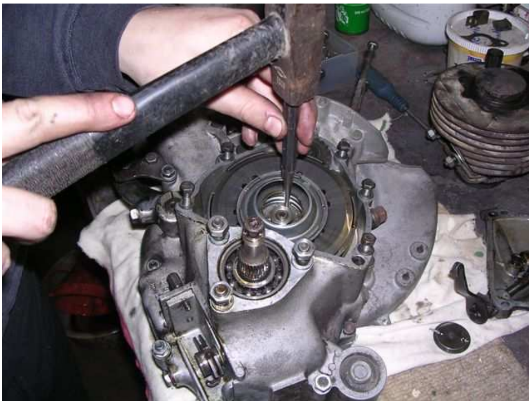
- der aufgebogene Teil der Sicherungsplatte mit kleinem Durchschlag platt klopfen
