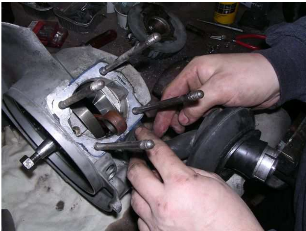
- Ansaugstutzen entfernen
