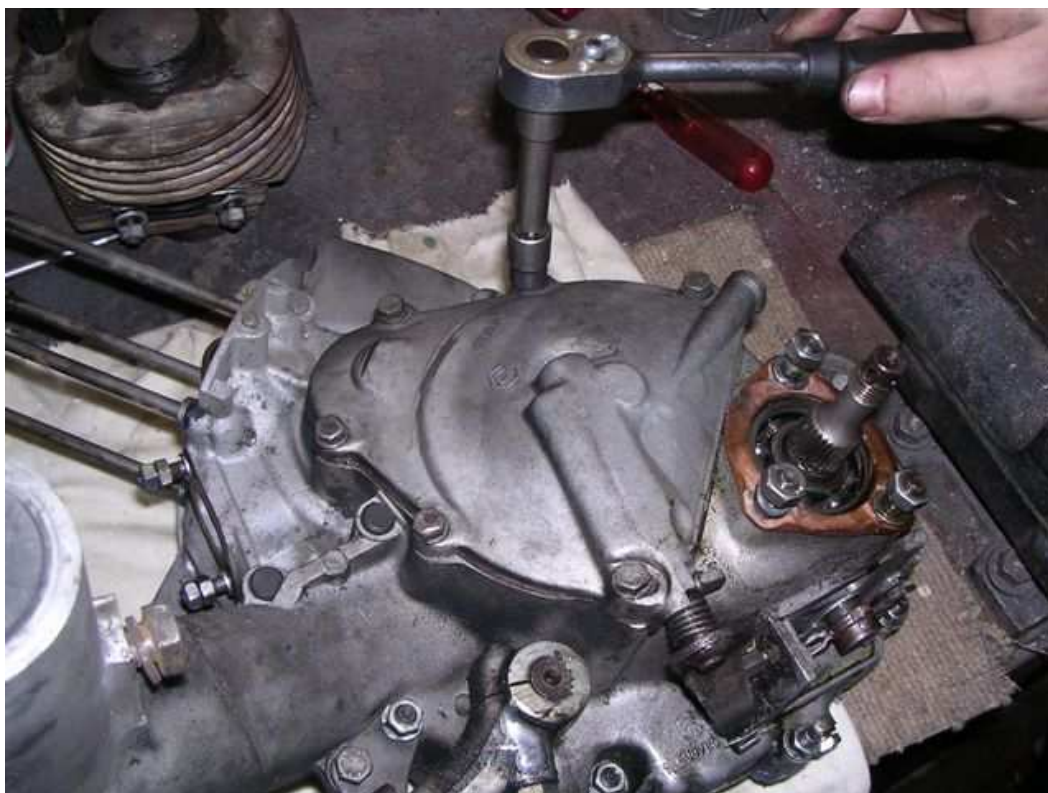
- Kupplungsdeckel abschrauben
